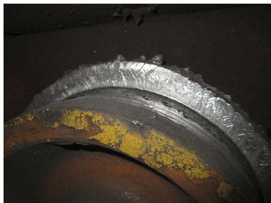
Фото 1. Износ реборды ходового колеса мостового крана
