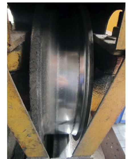
Многим владельцам грузоподъёмных кранов, передвигающихся по рельсам, знакома эта картина (см. фото 1). Известно, что одной из причин выхода ходовых колёс крана из строя является износ их реборд. Различают износ колёс по поверхности катания, подрез и утонение реборд колёс, а также вертикальный и боковой износ головок рельсов крановых путей. Выяснить причину износа колёс и рельсов – задача непростая.
